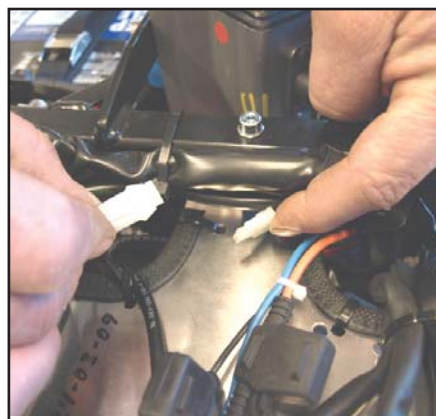
Kontakten i den andre enden monteres med kablen merket KM.
