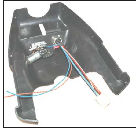
Byttes til et plastdeksel der timeteller er monteret.
