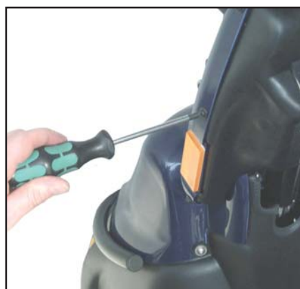
Bakerste plastskjerm demonteres vha. de seks plastskruene.
