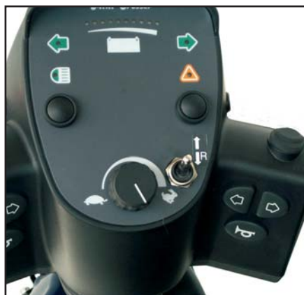
Forover-/bakoverkontakten montert på panelet.
