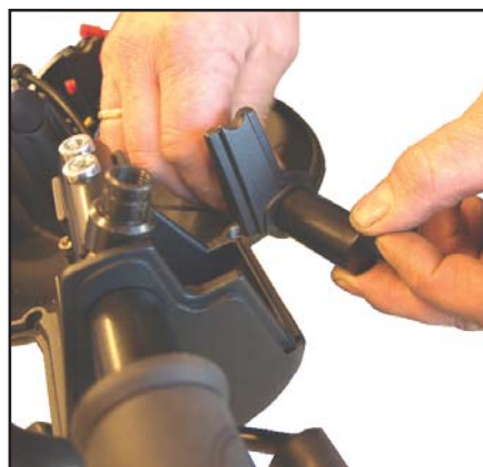
Skrus holder for speedometer på.
