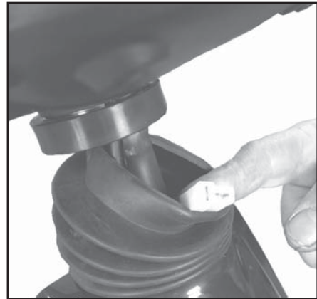
Finn kontakten merket KM i gummiskallet.
