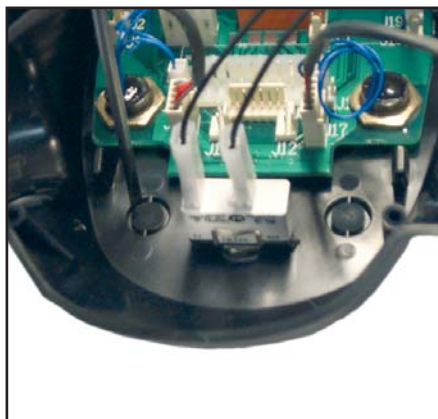
Skjær hull til forover-/bakoverkontakten.
