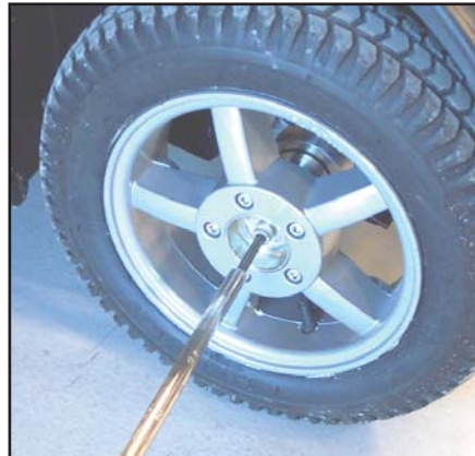
Ta settet og kåpen av og demonter venstre bakhjul.
