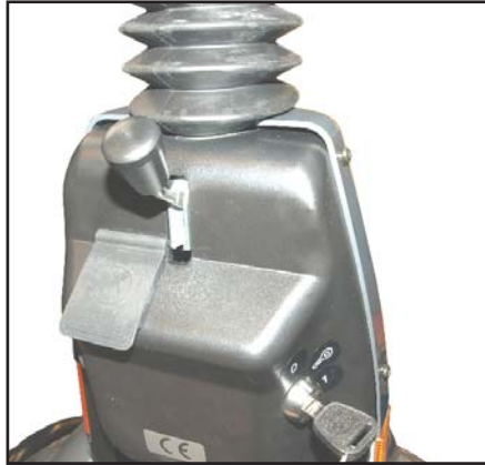
Demonter styrestammens plastdeksel.
