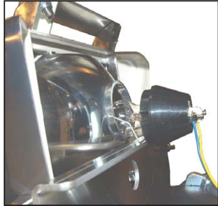
Bøylen skyves ned. Innfatning med pære kan nå tas ut og skiftes.
