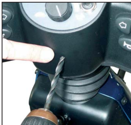
Bor et 6,8 mm hull som vist.
