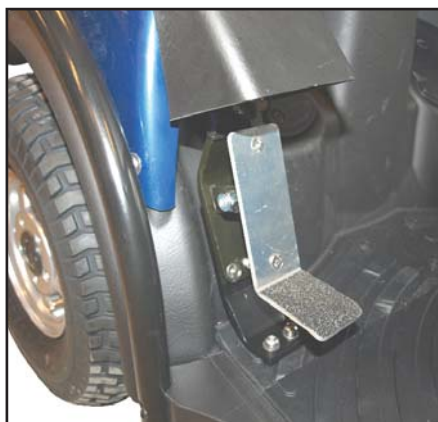
Gasspedalen kan plasseres på høyre eller venstre side, eller på midten. Programmeringen endres til "Single ended".
