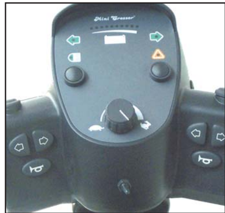
Monter betjeningspanel. Unngå å klemme/strekke ledningene.
