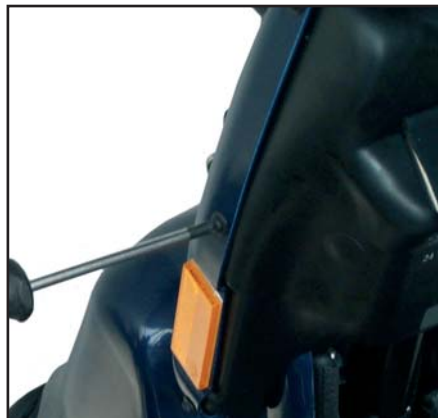
Demonter bakerste plastskjerm vha. de seks plastskruene.
