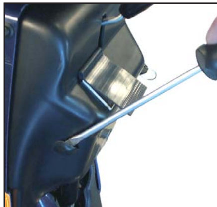
Gummipropp i plastdeksel fjernes.
