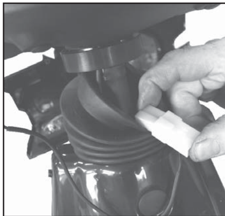
Monter kontakten og gjem kontakt og kabel under gummiskallet igjen.
