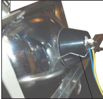
Lyspæren i frontlyset er festet med en bøyle.
