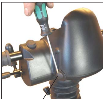
Ta ut proppen. Åpne betjeningspanelet.
