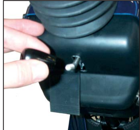
Ta plasthåndtaket av "Utløser for gassfjæring".
