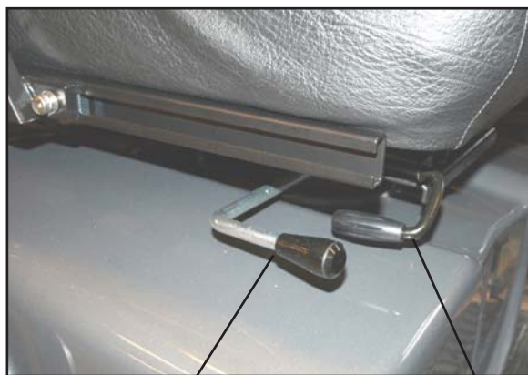
Utløserhåndtak for setedreining. Utløserhåndtak for sete frem/tilbake.
